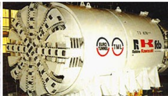
Europa, tunnelier T2 utilisé pour le forage de la galerie ferroviaire nord. On distingue nettement la tête de forage.
