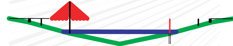
2 - Construction du tablier à partir du noeud du pylône
