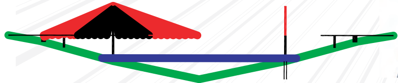
3 - Clavage du tablier en rive et construction du tablier en surencorbellement
