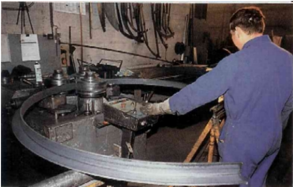
Cintrage à froid d'un profilé en cornière - Machine à trois galets (CETIM) - D.R.
