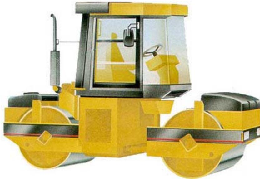
*Compacteur à cylindres (USIRF – Droits réservés)*
