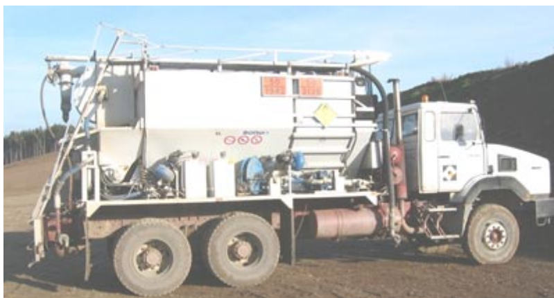
Camion de fabrication et de mise en œuvre d'explosifs en émulsion (droits réservés)
