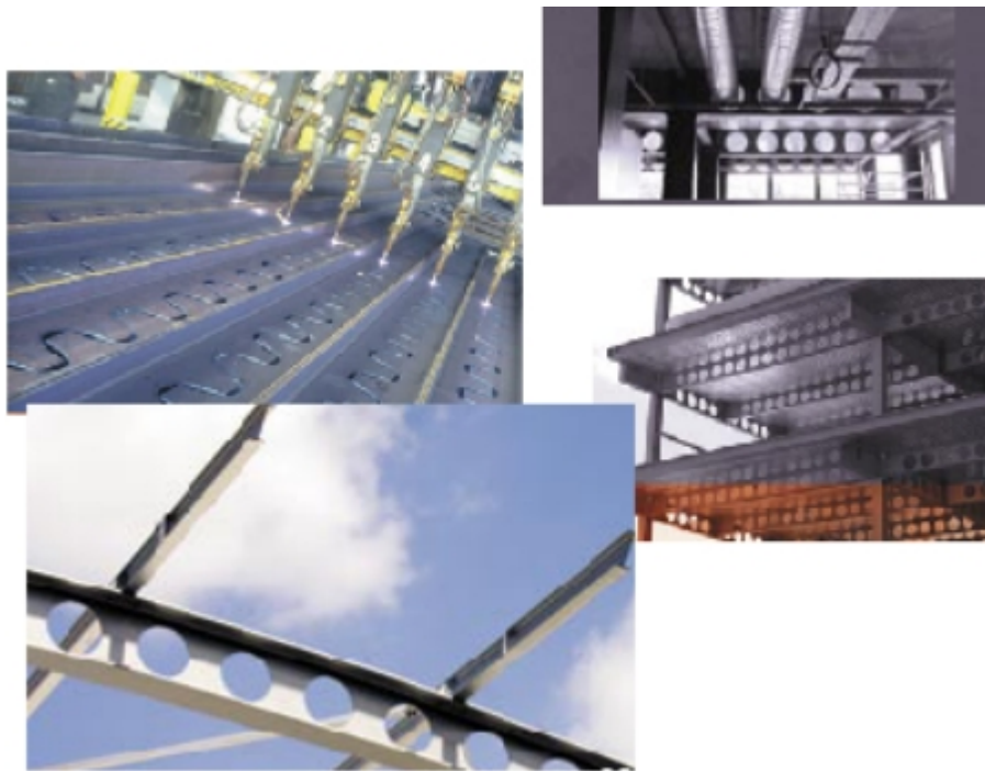
Fabrication et utilisation des poutrelles alvéolaires (Arcelor Long Products)
