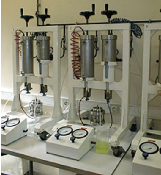
Appareil d'essai triaxial permettant d'appréhender la résistance du sol. (Droits réservés)
