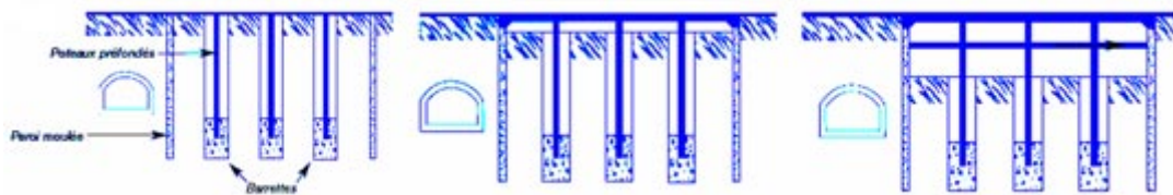
1 Paroi moulée et poteaux profonds 2 coulage de la dalle du rez-de-chaussée 3 terrassement à -2 et coulage plancher -1
